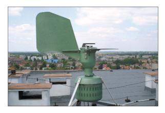
Fig. 1. Burkard volumetric trap
